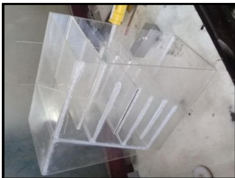
Figura 58. Pegado de láminas de acrílico en celda de EC.
