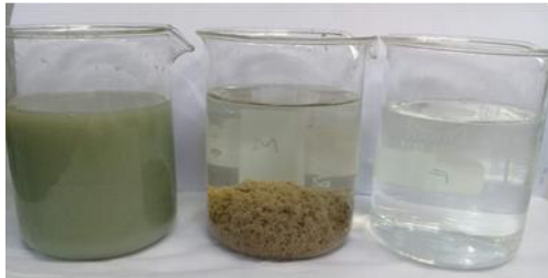
Figura 68. Tratamiento de fluentes a pH6 y 60V
