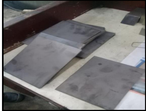
Figura 59. Electrodo de hierro para la celda de EC.
