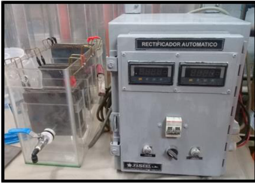
Figura 62. Celda de electrocoagulación con el rectificador de corriente DC.
