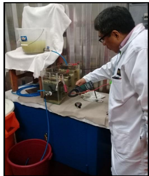
Figura 66. Control de amperaje en el proceso de electrocoagulación.
