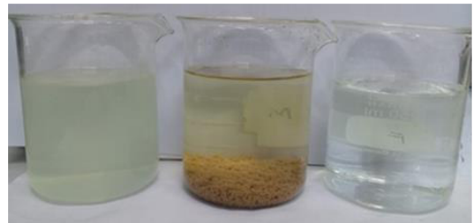
Figura 71. Tratamiento de fluentes a pH6 y 75V
