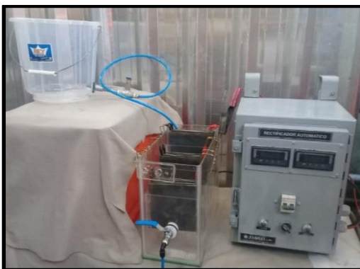
Figura 64. Sistema de EC completo para tratamiento de agua residual.
