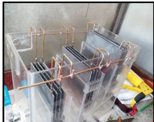
Figura 61. Celda de electrocoagulación en construcción.
