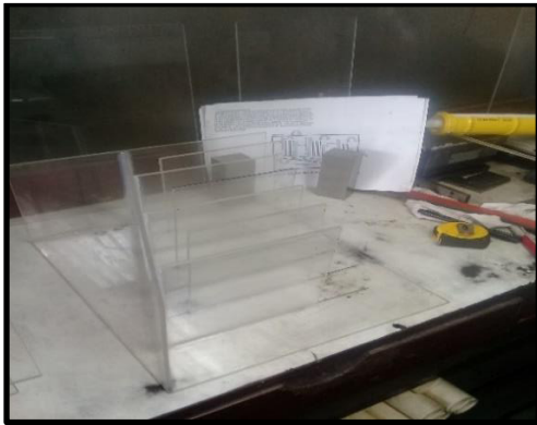
Figura 57. Pegado de láminas laterales de acrílico de celda de EC.
